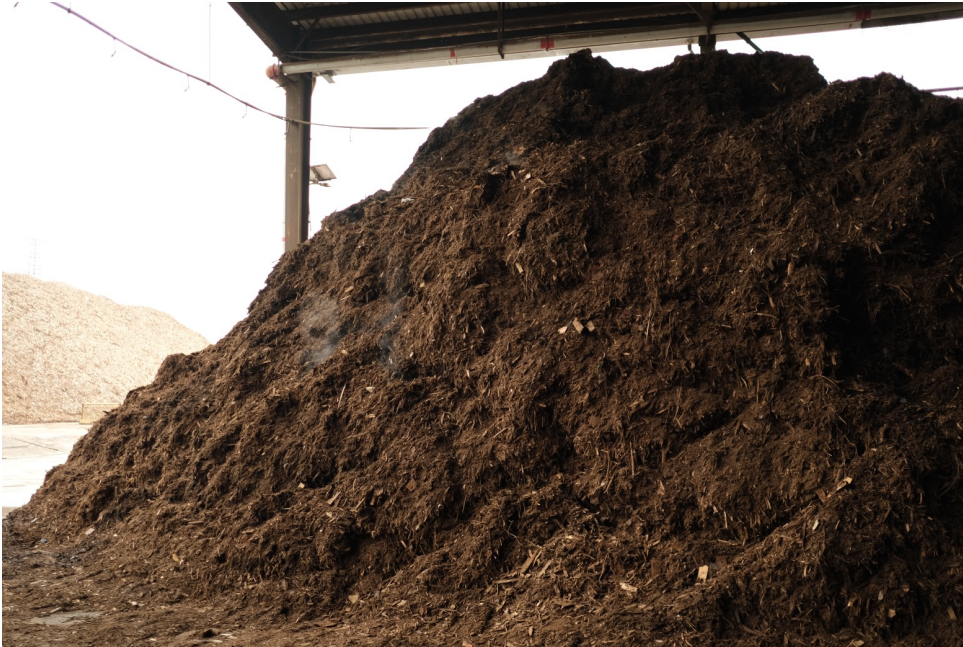
Centrale à Yibin (Sichuan) : pile de biomasse stockée en fermentation (gauche) et écrans de surveillance thermique dans la salle de contrôle (droite). Source : Camille Oulès, Mai 2026.
